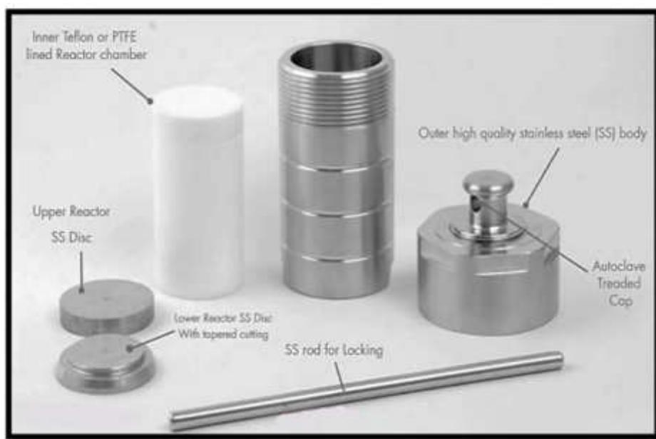
الشكل (1-3): صورة جهاز الضغط الحراري (Autoclave) المستعمل في البحث .
